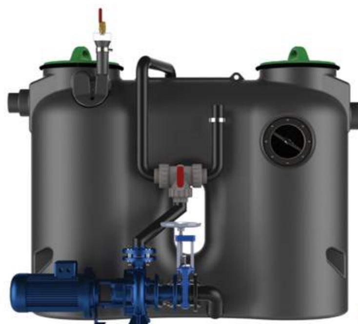
Жироотделитель модели PUMP-M оборудован системой ручного обслуживания 3-го типа с мощным смесительно-опорожняющим насосом, смотровым окном и ручным узлом заполнения. Ручной 3-ходовой клапан переключается на:
