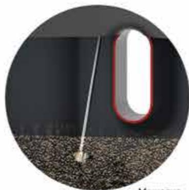
**Мешалка** Служит для перемешивания накопленного жира, осадка и воды для более эффективного опорожнения емкости.
