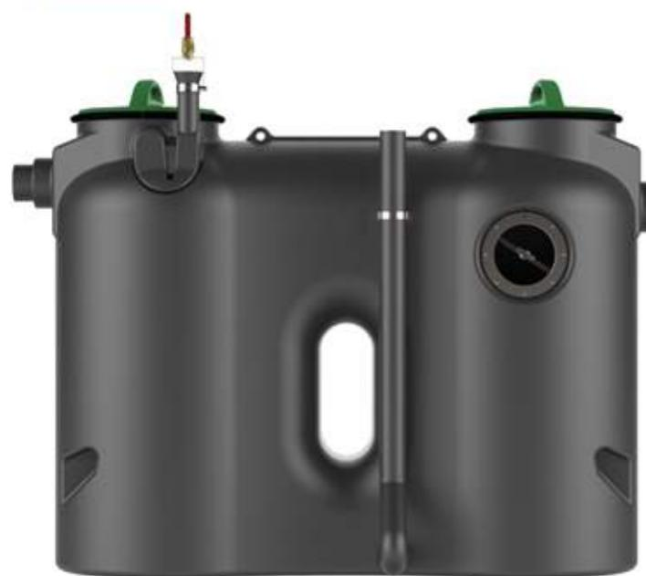
Модель PRIMA оснащен ручной системой опорожнения 1-го типа. Компоненты: смотровое окно, труба откачивания, узел заполнения свежей водой. Модель PRIMA предназначен для работы исключая распространение неприятных запахов. Толщина слоя отделенного жира определяется наблюдением через смотровое окно. Наколенный жир и твердый отстой удаляются при помощи ассенизационной машины через трубу откачивания. После опорожнения отделитель наполняется свежей водой.
